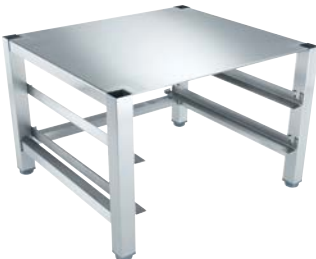
UO 40-60 Nyitott gépmagasító PTD 702/703/704 típusokhoz • Magasság: 30 cm • 3 oldalon zárt • A készülékekkel összezsavarozható • Nemesacél • Ma 300, Szé 600, Mé 600 mm
